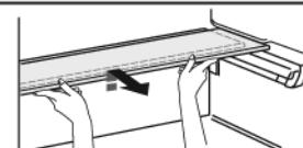
③ Толкнуть переднюю часть полки назад, чтобы соединить ее с задней.
