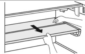
③ Поставить переднюю часть полки на заднюю. (Внимание: передняя часть полки должна располагаться под направляющей на внутренней стенке холодильника).
